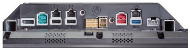
Auswählbare und aktualisierbare SurePort-Anschlüsse ermöglichen Einzelhändlern die Verwendung vorhandener Geräte und das Anschließen von Kunden- und Mitarbeitergeräten
