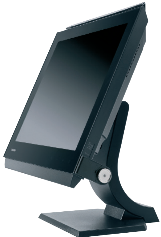
オプションのスタンドを使用したカウンター設置構成
