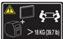
Данный предмет или узел весит от 18 до 32 кг. Поднимать его следует вдвоем. (C009)
