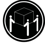
Данный предмет или узел весит от 32 до 55 кг. Поднимать его следует втроем. (C010)
