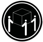
O peso deste componente ou unidade situa-se entre os 32 e os 55 kg (70,5 e 121,2 lb). São necessárias três pessoas para mover este componente ou unidade em segurança. (C010)
