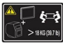
Маса цієї частини або блока становить 18—32 кг (39,7—70,5 фунта). Безпечно підняти цю частину або блок можна лише вдвох. (C009)
