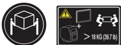
Este componente o unidad pesa entre 18 y 32 kg (39,7 and 70,5 lb). Para levantar este componente o unidad de forma segura se necesitan dos personas. (C009)
