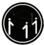
Težina ovog dela ili jedinice je između 32 i 55 kg (70,5 i 121,2 lb). Potrebne su tri osobe za bezbedno podizanje ovog dela ili jedinice. (C010)
