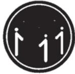
Маса цієї частини або блока становить 32—55 кг (70,5—121,2 фунта). Безпечно підняти цю частину або блок можна лише втрьох. (C010)
