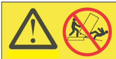
**NEBEZPEČÍ:** Těžká zařízení – v případě nesprávné manipulace může dojít ke zranění osob nebo k poškození zařízení. (D006)
