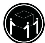
Este componente o unidad pesa entre 32 y 55 kg (70,5 y 121,2 lb). Para levantar este componente o unidad de forma segura se necesitan tres personas. (C010)
