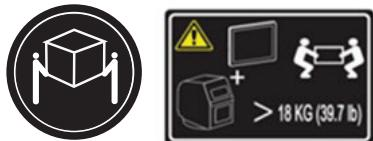
O peso deste componente ou unidade situa-se entre os 18 e os 32 kg (39,7 e 70,5 lb). São necessárias duas pessoas para mover este componente ou unidade em segurança. (C009)
