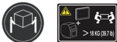
Težina ovog dela ili jedinice je između 18 i 32 kg (39,7 i 70,5 lb). Potrebne su dve osobe za bezbedno podizanje ovog dela ili jedinice. (C009)
