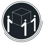
Hmotnost této součásti nebo jednotky se pohybuje mezi 32 a 55 kg. K bezpečné manipulaci jsou zapotřebí tři osoby. (C010)
